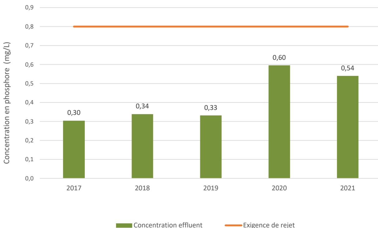
**Figure 5.4: Concentration en phosphore total à l'effluent**
