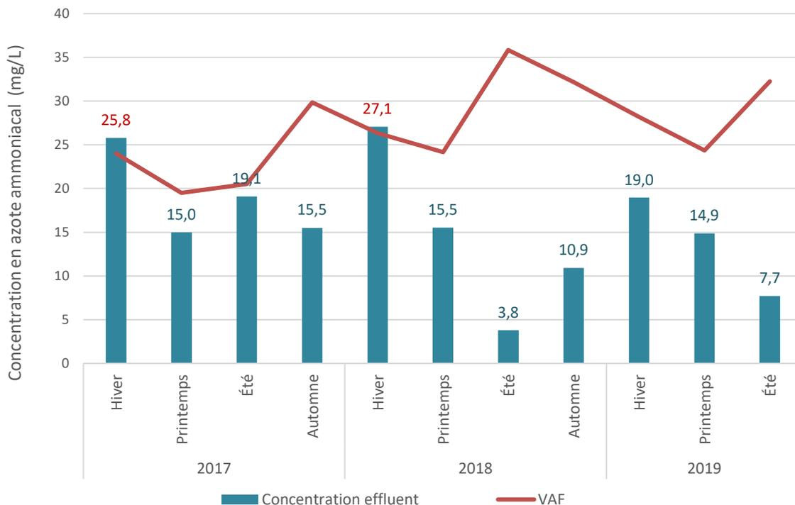
**Figure 6.2 : Concentration en azote ammoniacal et VAF à l'effluent**
