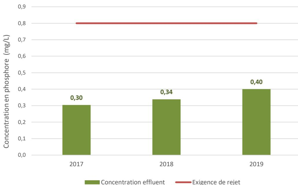
**Figure 6.4: Concentration en phosphore total à l'effluent**
