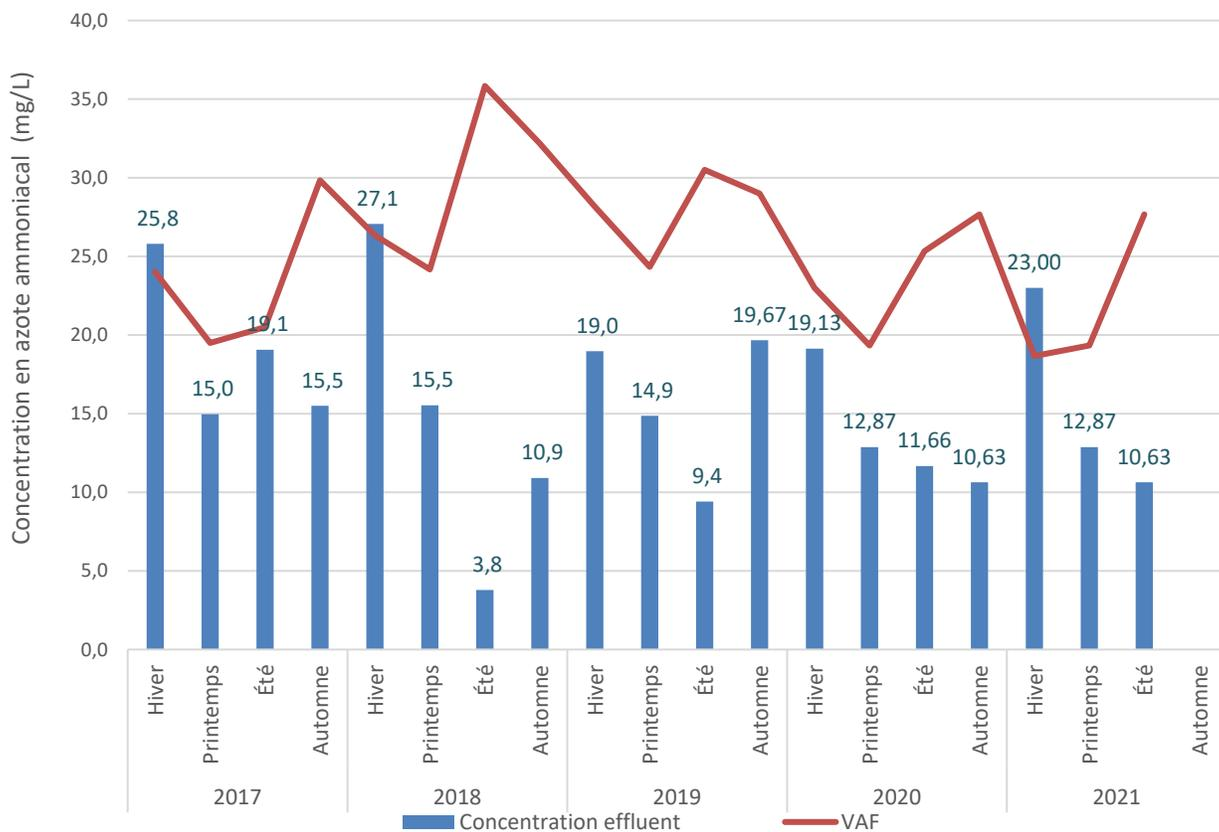
**Figure 5.2 : Concentration en azote ammoniacal et VAF à l'effluent**
